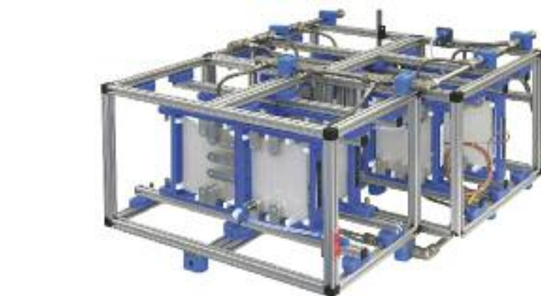
Méso réacteur Corning : les procédés intensifiés remplacent le batch.
