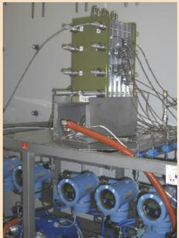
Le réacteur avec un design en carbure de silicium.
